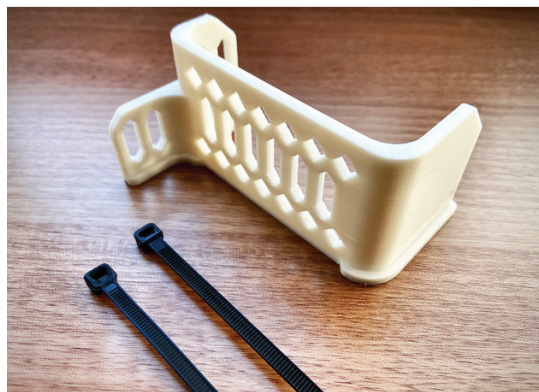
Slika 3. 3D štampanje ARMIE-a i instalisanje uz pomoć plastičnih vezica
